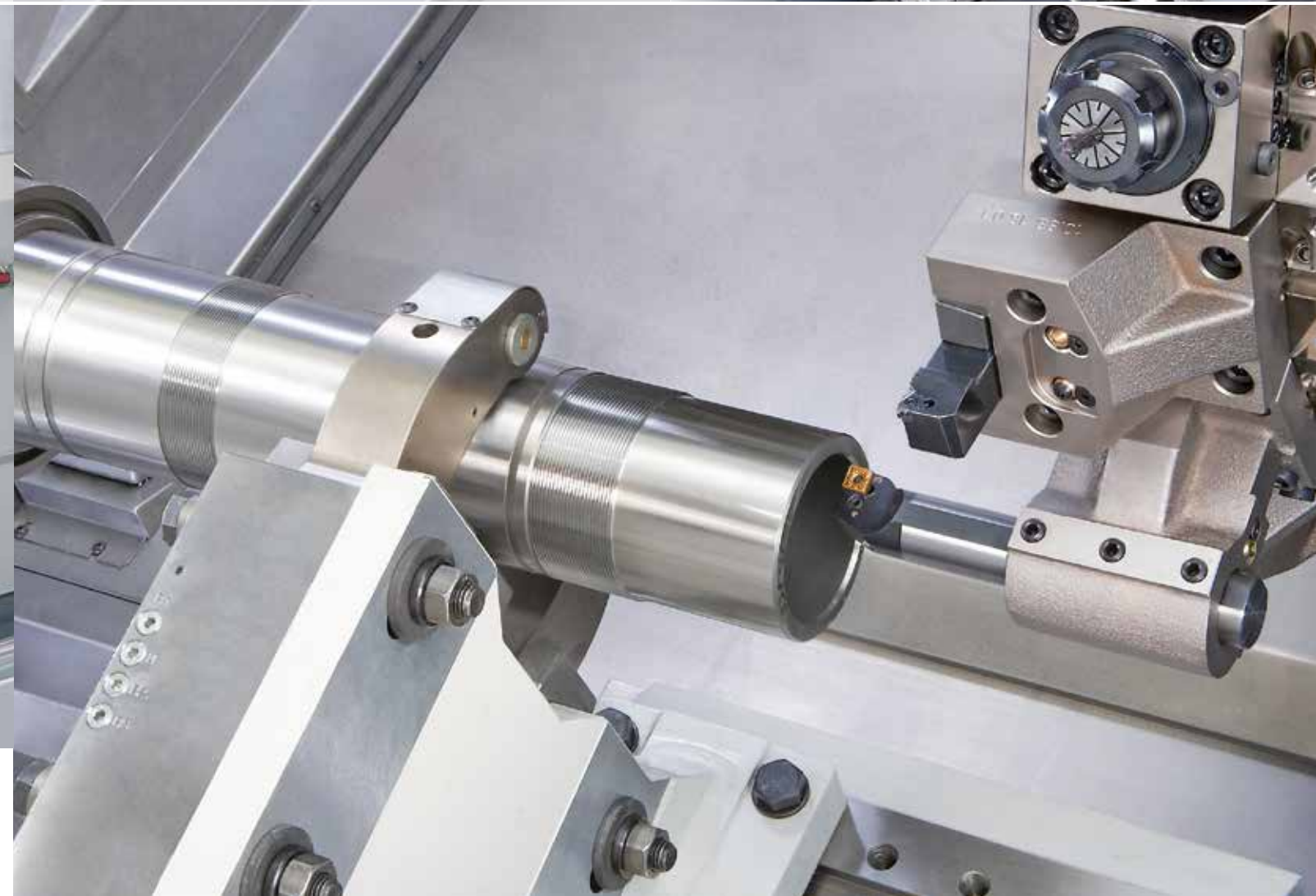
Reitstock "B-Achse". Standard für die B750. Option für die B1250.
