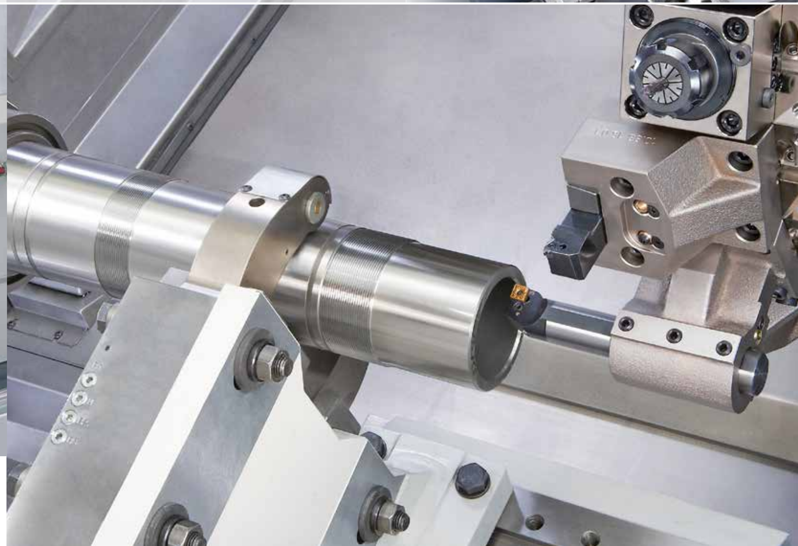
Contre-pointe "axe B" standard sur la B750, option sur la B1250.
